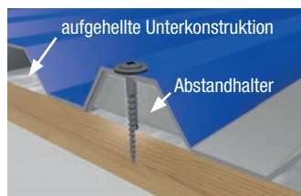
Querschnitt Befestigung der Überlappung
